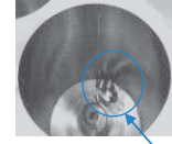
Delme durduğunda talaşlar alt kısma yapışır.
